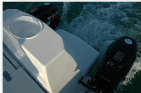
*El bloque de la plataforma equipa de lavamanos, con grifo-ducha alimentado por bomba de 12 V y depósito de agua de 60 litros.*
