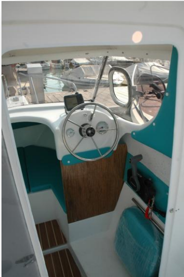
Puesto del piloto protegido. La cabina equipa escotilla lateral para la ventilación. El asiento es abatible.
