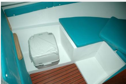
Espacio reservado para inodoro químico.
