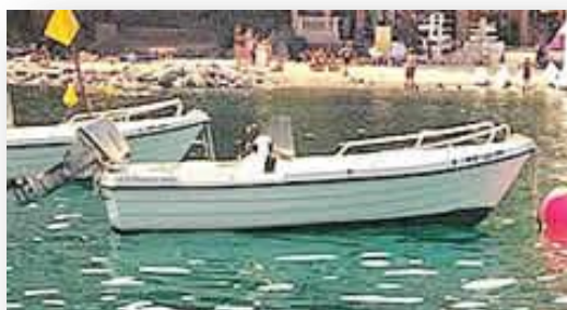
La popa de gran anchura, permite instalar motores de hasta 40 CV.
