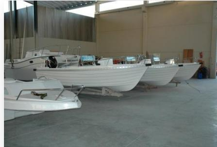
*Los materiales utilizados para la construcción, garantizan una longevidad excepcional, estando todos ellos adaptados al medio marino, como el gel-coat (pintura del casco) de calidad isoftálica, para prevenir la ósmosis, los herrajes y la tornillería son de acero inoxidable 316.*
