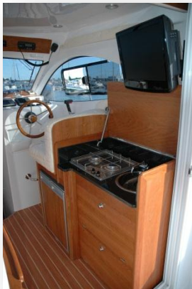
El bloque de cocina tiene hornillo con dos fuegos y fregadero de inox sobre encimera de granito. Bajo el hay espacio para el menaje y horno microondas. La nevera de 12 V. tiene 80 litros de capacidad.
